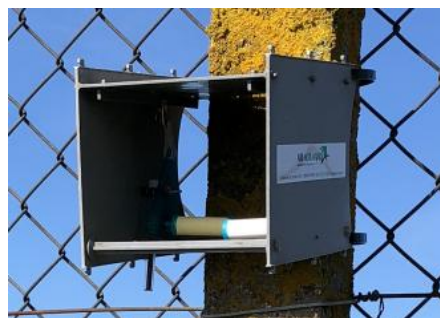
Figure 2 : Échantillonneur passif RADIELLO® avec sa membrane blanche sur support prêt à être exposé.
