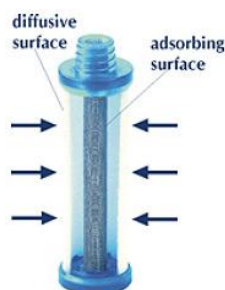
Figure 2 : Échantillonneur passif RADIELLO® avec sa membrane blanche sur support prêt à être exposé.
