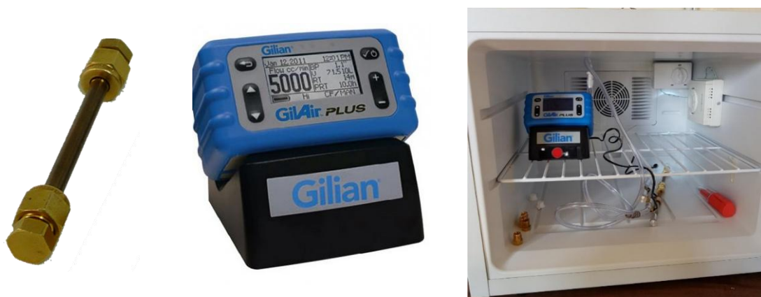
Figure 1 : Matériel de prélèvement utilisé pour la mesure du 1,3-butadiène avec de gauche à droite un tube actif, une pompe et une enceinte de mesure à température régulée installée dans un bâtiment.
