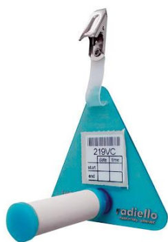
Figure 2 : Échantillonneur passif RADIELLO® avec sa membrane blanche sur support prêt à être exposé.
