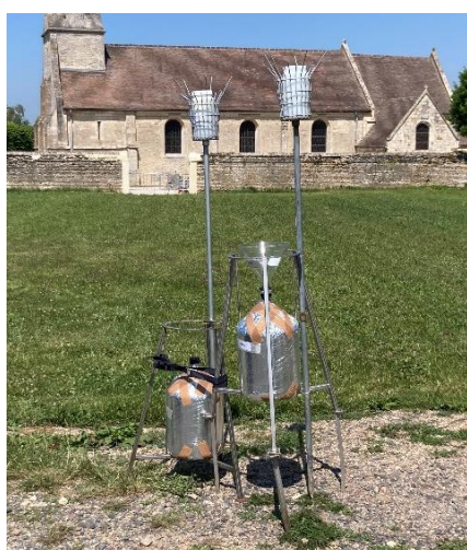
Jauges de dépôts sur le site d'Escoville et blanc terrain (jauges non ouvertes)
