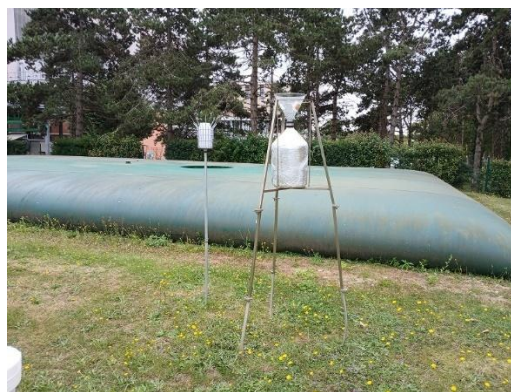
Jauges de dépôt sur le site de mesure de la SIRAC
