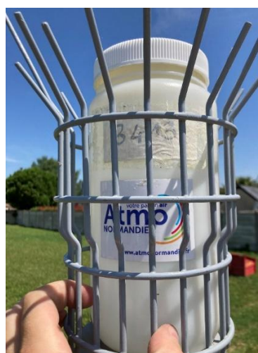
Détail d'une jauge Bergerhoff destinée à la mesure des dépôts des métaux
