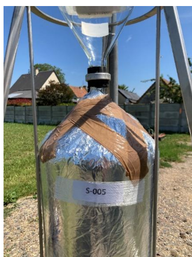
Détail d'une jauge Owen destinée à la mesure des dépôts des dioxines furanes et des PCB
