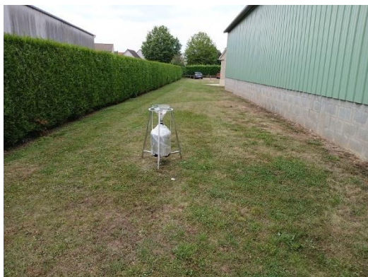
Jauge de dépôt sur le site de mesure de Sainte-Honorine-la-Chardonnette
