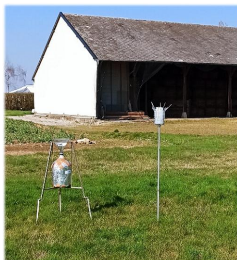
Figure 2 : Installation du matériel sur les sites de mesures (jauges de dépôts OWEN pour les dioxines et PCB et collecteurs BERGERHOFF pour les métaux)
