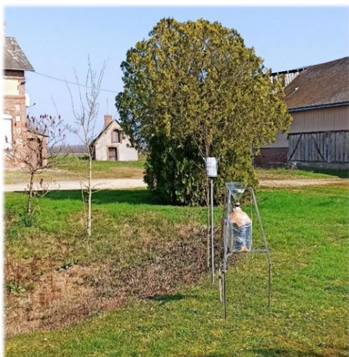
Figure 2 : Installation du matériel sur les sites de mesures (jauges de dépôts OWEN pour les dioxines et PCB et collecteurs BERGERHOFF pour les métaux)
