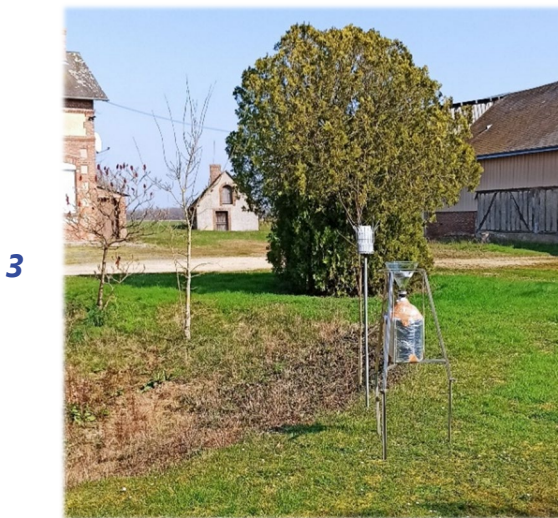
Figure 2 : Installation du matériel sur les sites de mesures (jauges de dépôts OWEN pour les dioxines et PCB et collecteurs BERGERHOFF pour les métaux)
