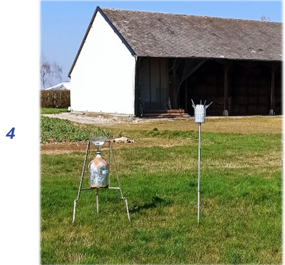
Figure 2 : Installation du matériel sur les sites de mesures (jauges de dépôts OWEN pour les dioxines et PCB et collecteurs BERGERHOFF pour les métaux)
