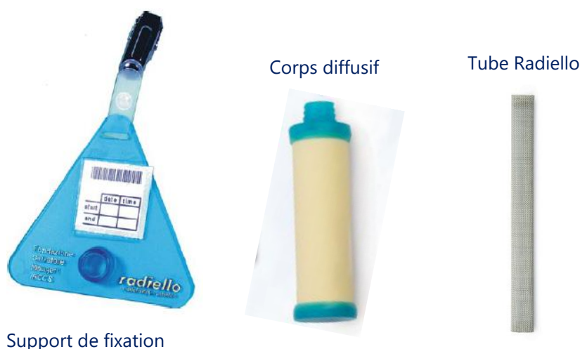
Figure 11 : Éléments constitutifs d'un tube passif Radiello®
