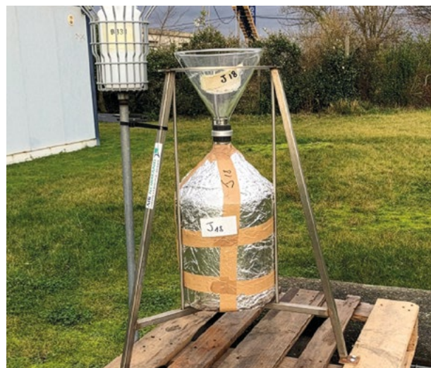
Jauges de dépôt utilisées dans le cadre de l'observatoire des retombées atmosphériques : à gauche, une jauge Bergerhoff pour collecter les métaux, à droite, une jauge Owen pour collecter les dioxines.
