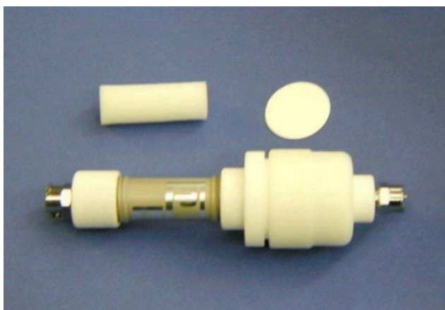
Cartouche de prélèvement dans le Préleveur (mousse polyuréthane PUF+ filtre quartz de 47 mm) exposée durant 7 jours
