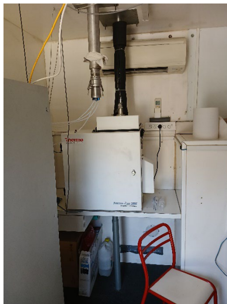
Appareil de prélèvement des pesticides (avec tête de prélèvement PM10)
