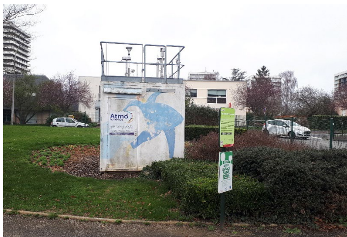
Station de mesure de Caen Chemin Vert (avec têtes de prélèvement des différents appareils en toiture)
