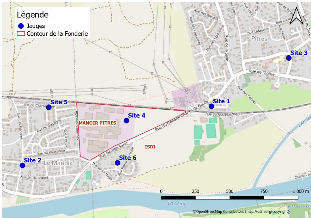
Figure 1 : Points de mesure des retombées (jauges) sur le secteur de Pitres et du Manoir en 2024.
