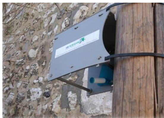
Figure 2 : Échantillonneur passif Radiello® avec sa membrane blanche sur support prêt à être exposé.
