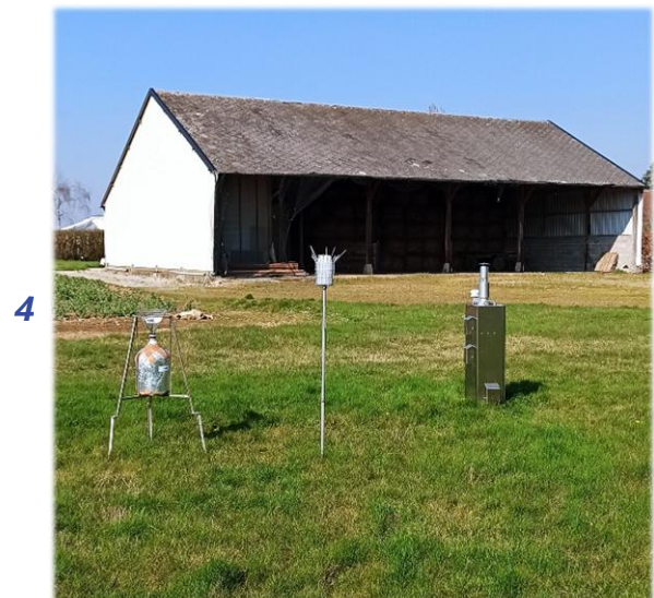
Figure 1 : Installation du matériel sur les sites de mesures (jauges de dépôts OWEN pour les dioxines et collecteurs BERGERHOFF pour les métaux, complétées par un appareil de prélèvement des métaux particuliers dans l'air ambiant sur deux des sites)
