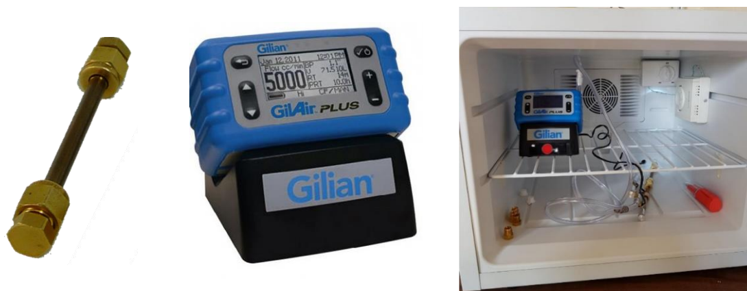
Figure 2 : Matériel de prélèvement utilisé pour la mesure du 1,3-butadiène et du benzène avec de gauche à droite un tube actif, une pompe et une enceinte de mesure à température régulée installée dans un bâtiment.
