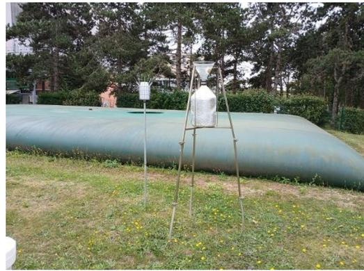
Jauges de dépôt sur le site de mesure de la SIRAC
