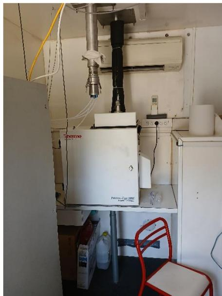
**Appareil de prélèvement des pesticides
