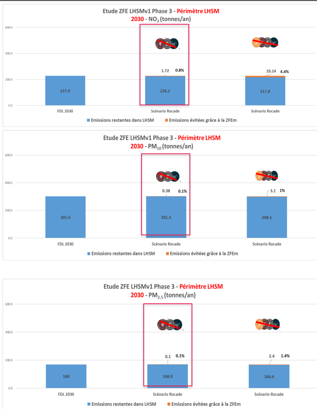
Graphique 6-15 : Périmètre LHSM : impact sur les émissions de NO 2 , de PM 10 et de PM 2.5 de la mise en œuvre du scénario P3 CA4 2030.
