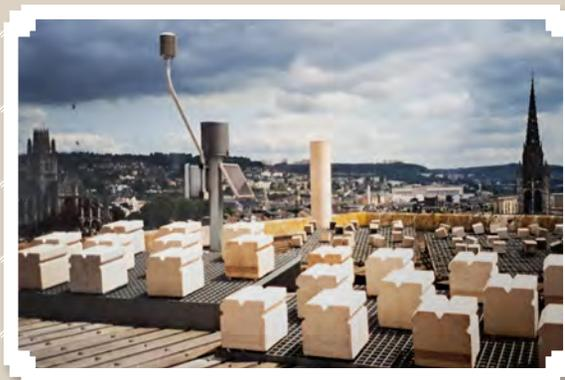
Depuis le printemps 95 et pour une durée de 10 ans, de petits échantillons de pierre (appelés «éprouvettes») en calcaire, sont exposés au sommet de la cathédrale de Rouen. Tous les mercredis, un technicien d'Air Normand y grimpe pour recueillir les eaux de pluie. Etude menée par le Laboratoire de Recherche des Monuments Historiques, sur 2 autres cathédrales de France (Reims et Saint-Denis).
