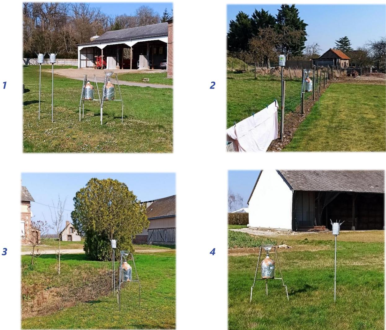
Figure 1 : Installation du matériel sur les sites de mesures (jauges de dépôts OWEN pour les dioxines et collecteurs BERGERHOFF pour les métaux, réalisation d'un blanc terrain sur l'un des sites)
