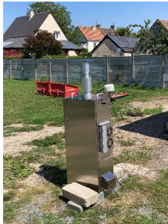
Appareil de prélèvement des métaux particulaires dans l'air ambiant (sur filtres)
