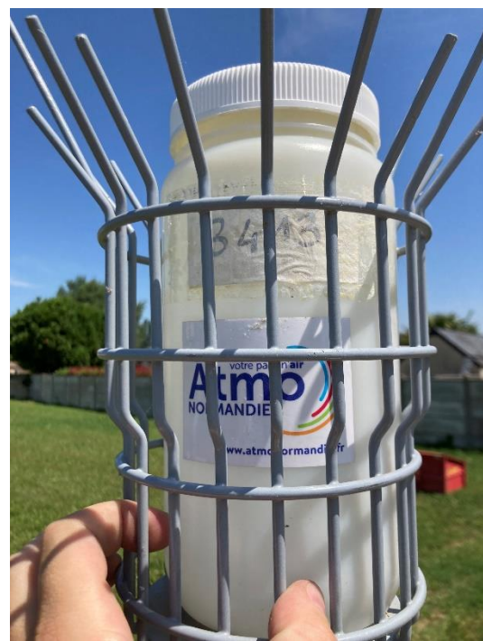
Jauge Bergerhoff destinée à la mesure des dépôts de métaux
