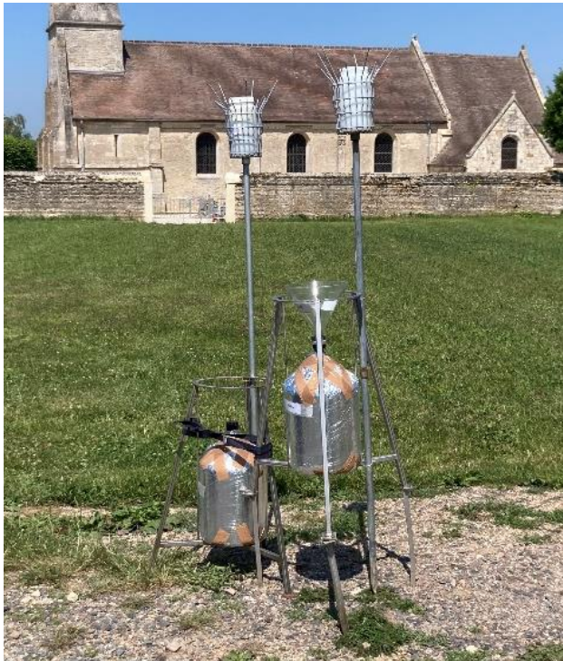
Jauges de dépôts (voir le détail ci-dessous) et blanc terrain (jauges non ouvertes)
