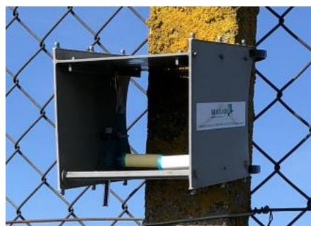
**Figure 4 : Echantillonneur passif RADIELLO® avec sa membrane blanche sur support prêt à être exposé.**
