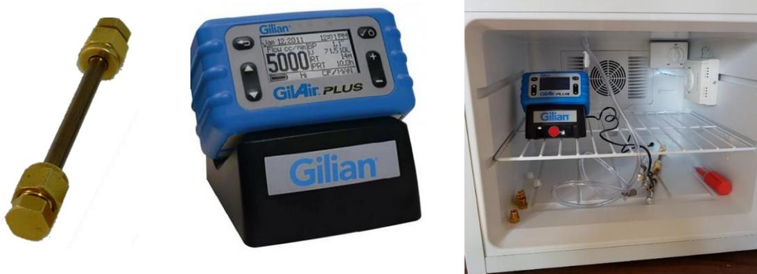
**Figure 3 : Matériel de prélèvement utilisé pour la mesure du 1,3-butadiène et du benzène avec de gauche à droite un tube actif, une pompe et une enceinte de mesure à température régulée installée dans un bâtiment.**
