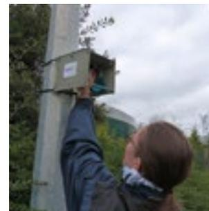
Pose d'un échantillonneur pour l'analyse de NH<sub>3</sub> et H<sub>2</sub>S en limite de propriété du méthaniseur.
