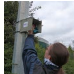
Pose d'un échantillonneur pour l'analyse de NH 3 et H 2 S en limite de propriété du méthaniseur.
