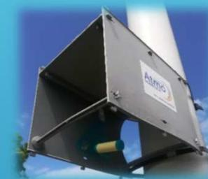
Tube passif : piégeage sur 7 jours suivi d'une analyse en laboratoire
