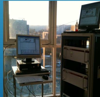
Un instrument compact de terrain (moins sensible) pour mesurer les COV en temps réel dans l'air
