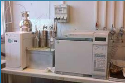
Instrument de laboratoire ou terrain pour mesurer les COV en temps réel dans l'air
