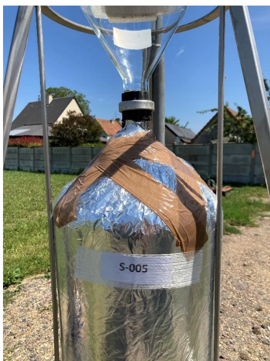
Jauge Owen destinée à la mesure des dépôts de dioxines furanes
