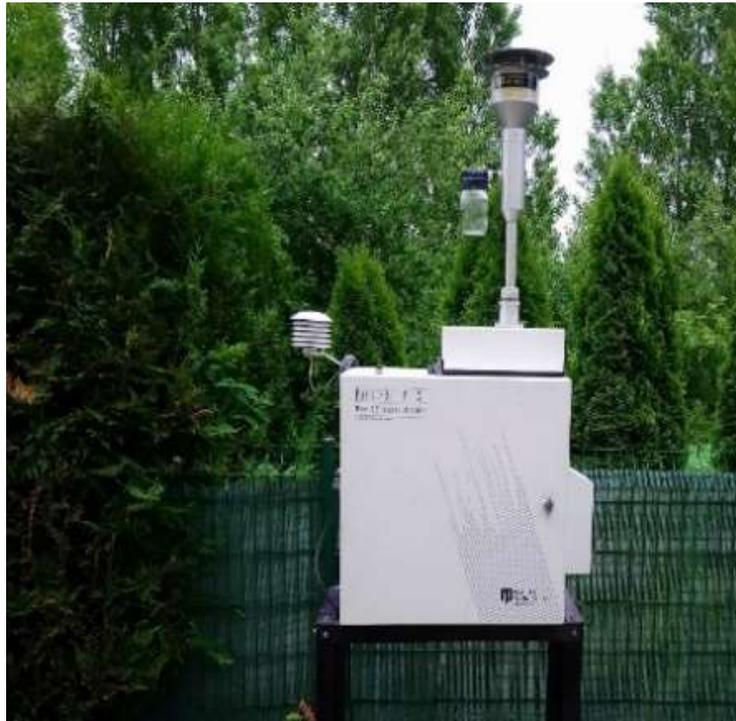
**Figure 2 : Appareil de prélèvement Partisol (avec tête de prélèvement PM10)**
