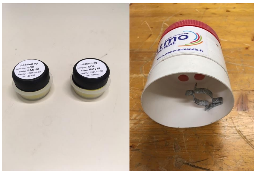
Figure 6 : Photographies des échantillonneurs passifs SO 2 et du boîtier d'installation des tubes, Atmo Normandie, 2021.
