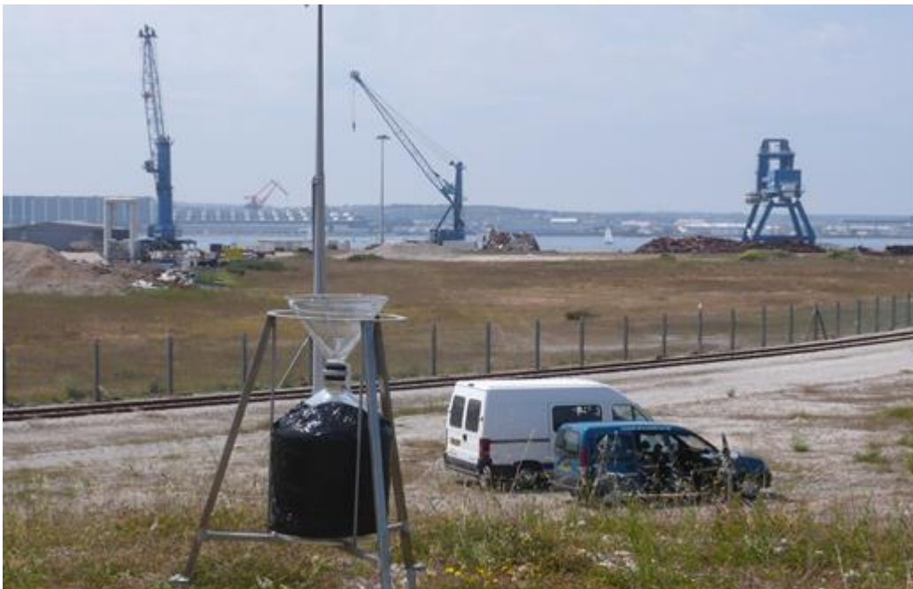
Figure 1 : Jauge Owen installée sur le terminal charbonnier
