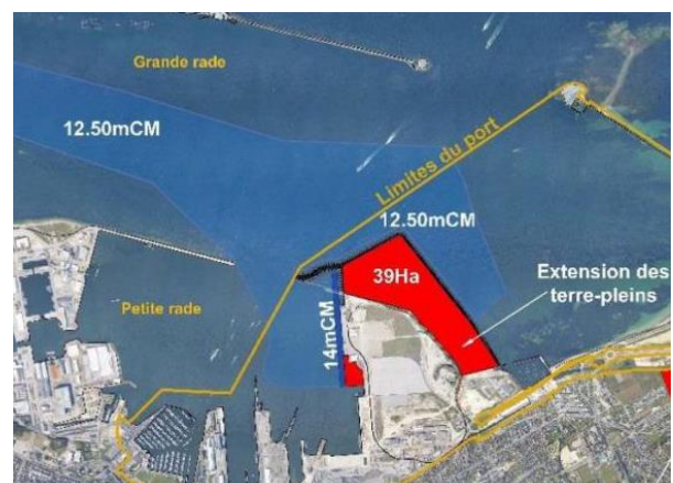
Figure 16: Travaux d'extension du port de Cherbourg
