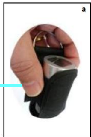
Figure 12 : Photo d'une mesure d' H_2S avec le microcapteur CAIRPOL
