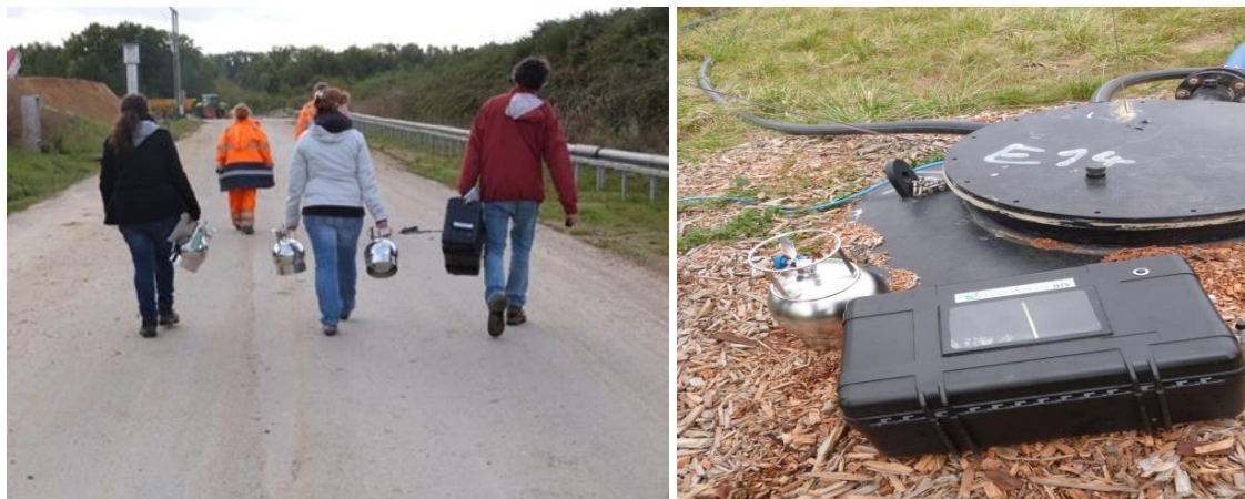
Figure 13 : Photos des prélèvements sur le terrain à l'aide des canisters et de la valise de prélèvement (sacs tedlar)
