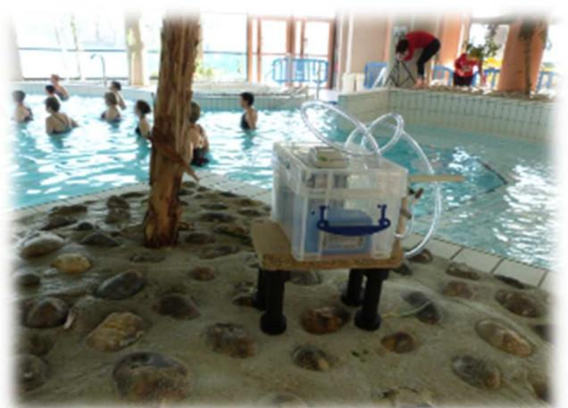
A la demande de l'ARS les prélèvements ont été effectués dans la mesure du possible au plus près de la surface d'eau, en veillant à ce que les projections d'eau n'impactent pas les prélèvements. De ce fait, les prélèvements n'ont pas tous été effectués à la même hauteur.
