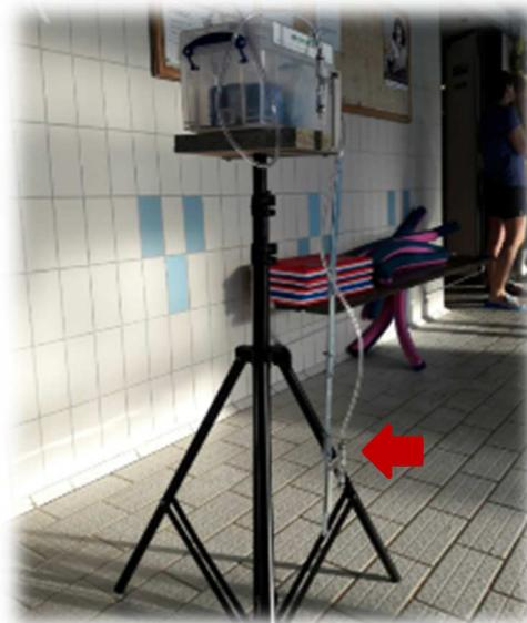
Le plan avec les emplacements des points de prélèvement dans la piscine de Breteuil est présenté sur la Figure 5. Les prélèvements des THM ont été effectués à deux hauteurs différentes, 1,00 mètre (point n°1 et 2) et de 0,3 mètre (point n°2bis) par rapport à la surface d'eau.
