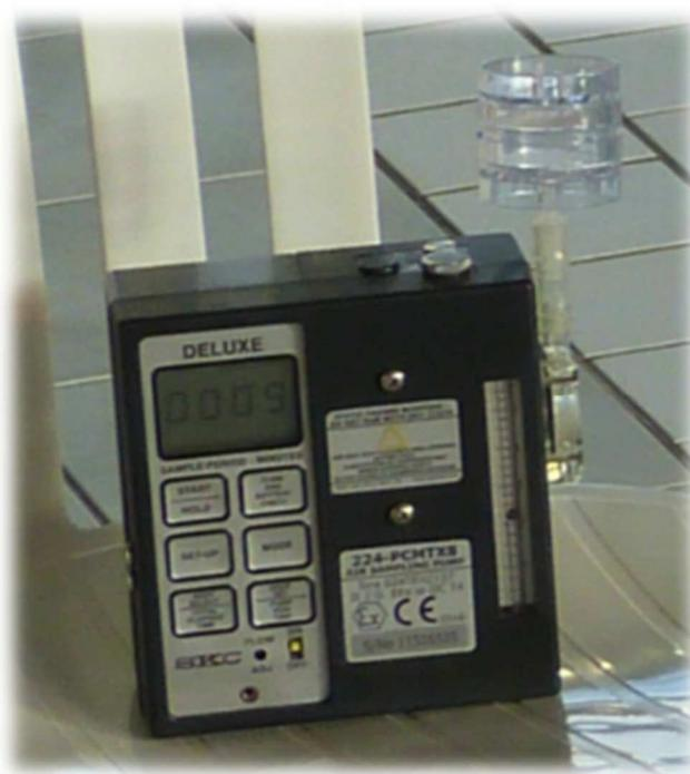
Figure 6 : Système de prélèvement « Triklorame »
