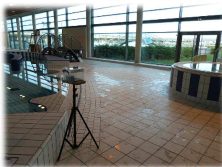
Le plan avec les emplacements des points de prélèvement dans la piscine de Dieppe est présenté sur la Figure 4. Les prélèvements des THM ont été effectués à une hauteur d'un mètre par rapport à la surface d'eau.
