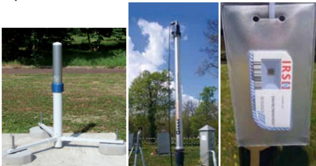
Figure 4 : Dispositifs de mesure du débit de dose gamma ambiant [1]
