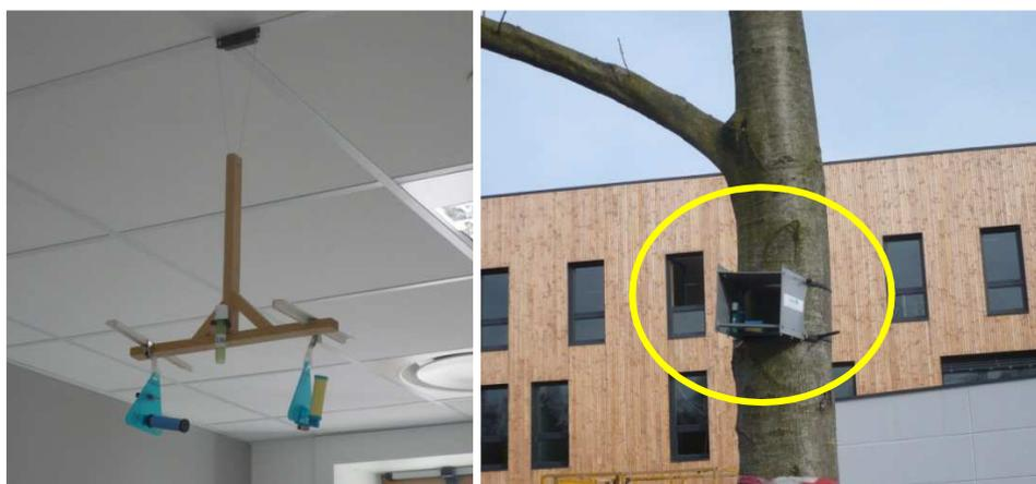
Figure 3 : exemples d'installation des tubes passifs sur site (à gauche : à l'intérieur ; à droite : à l'extérieur)
