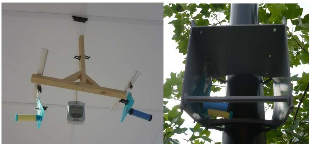
Figure 3 : exemple d'installation des tubes passifs sur site (à l'intérieur à gauche, à l'extérieur à droite)
