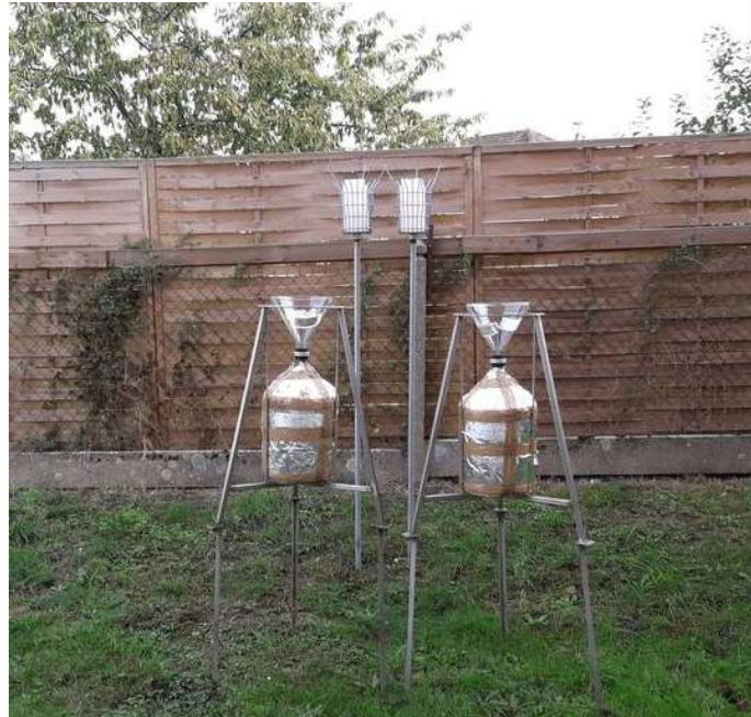
Figure 4 : Exemple de photo d'une deux jauges OWEN en verre avec entonnoir (pour les PCB) et de 2 jauges BERGERHOFF en plastique (pour les métaux), à la station RETIA 2
