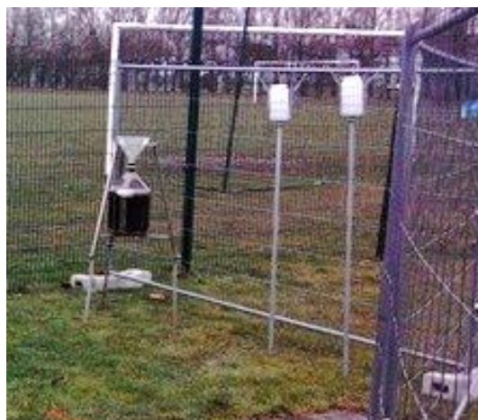
Figure 6 : Exemple de photo d'une jauge OWEN en verre avec entonnoir (pour les PCB) et de 2 jauges BERGERHOFF en plastique (pour les métaux)
