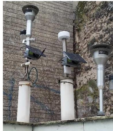
Figures 4a,b: capteur Clarity Node-S et installation sur la station de JUS
