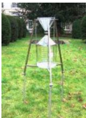
Figure 19 : jauge de type Owen (Source : Air Normand, 2009)
