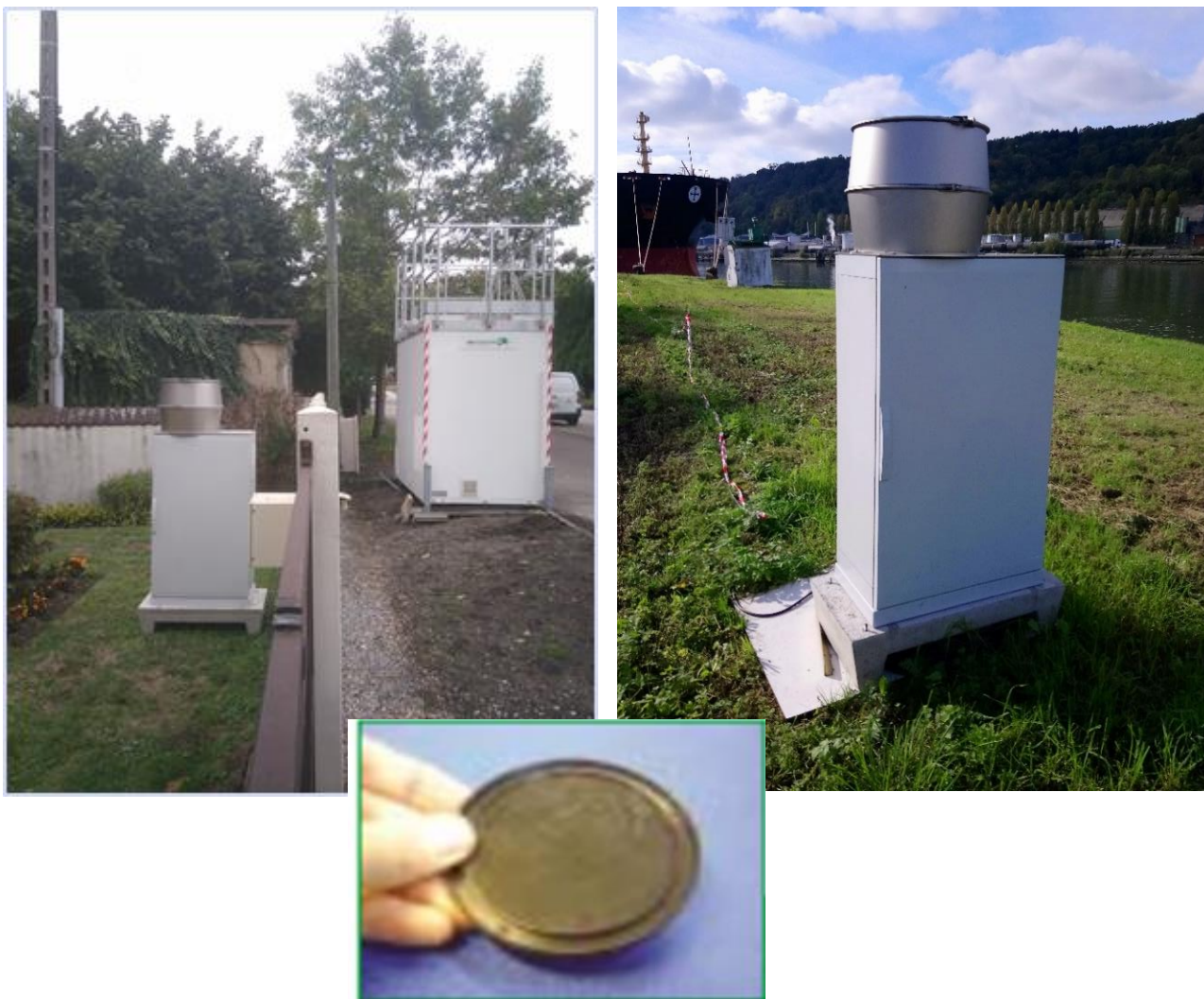
Figure 5 : Photos des analyseurs de dépôt de poussières automatique ADA (ALOATEC) à Quenneport (à gauche sur la photo) et sur le terrain portuaire à Petit Couronne (à droite) ainsi que d'une lamelle de collecte des dépôts secs journaliers
