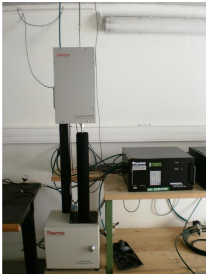
Figure 3 : Photo d'un analyseur des poussières en suspension PM 10 (TEOM-FDMS) à l'intérieur d'une station de mesure
