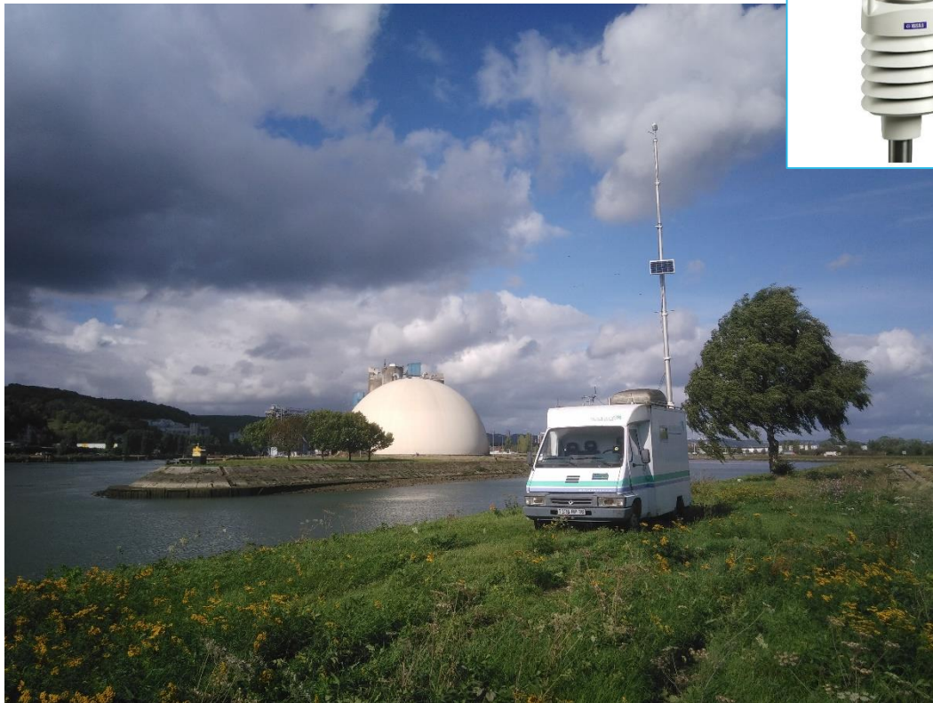
Figure 6 : Camion laboratoire sur le terrain portuaire (Petit Couronne), équipé d'un mât météorologique, d'un panneau solaire et d'un capteur météorologique (voir photo ci-dessus)
