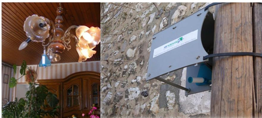
Figure 2 : échantillonneur passif en air intérieur (à gauche) et en air extérieur sous abri de protection (à droite)
