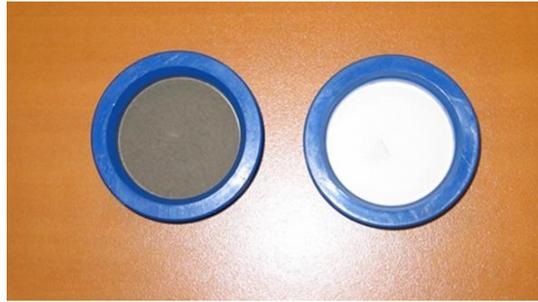
Figure 7 Filtres destinés à la mesure des métaux en air ambiant (à gauche après prélèvement, à droite avant)
