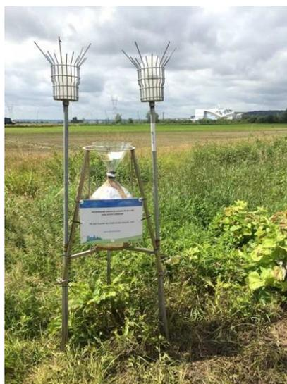
Figure 1 : Exemple de photographie des jauges de dépôt
