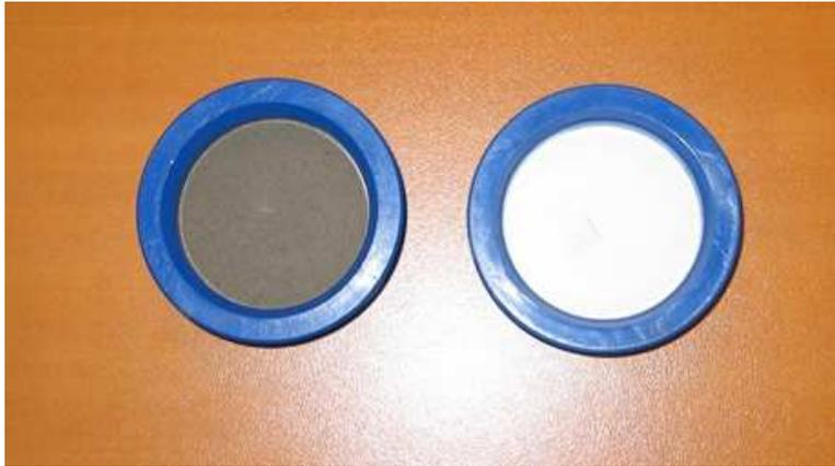
**Figure 2 Exemple de photo de filtres destinés à la mesure des métaux en air ambiant (à gauche un filtre après prélèvement, à droite un filtre vierge)**
