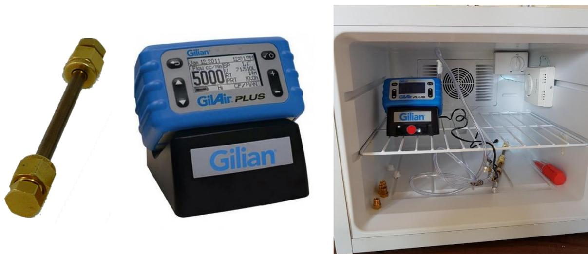
Figure 3 : Matériel de prélèvement utilisé pour la mesure du 1,3-butadiène et du benzène avec de gauche à droite un tube actif, une pompe et une enceinte de mesure à température régulée installée dans un bâtiment.
