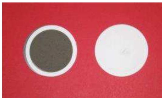
**Figure 2 : Exemple de photos de filtres (à gauche un filtre après prélèvement des poussières PM<sub>10</sub>, à droite un filtre vierge)**
