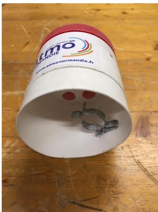
Photographie 4 : Boîte utilisé pour installer les tubes passifs SO<sub>2</sub>, Atmo Normandie, 2019.
