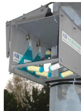
Figure 2 - Echantillonneurs passifs dans leur boîte de protection
