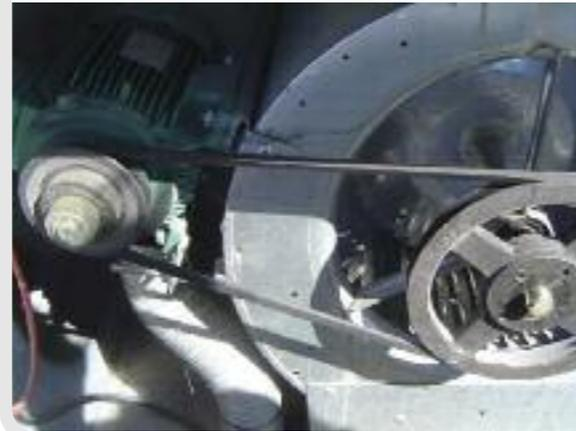
Photo 3 : Courroie ventilateur en mauvais état
