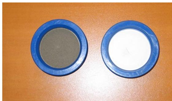
Filtres (à gauche un filtre après prélèvement des poussières PM<sub>10</sub>, à droite un filtre vierge)
