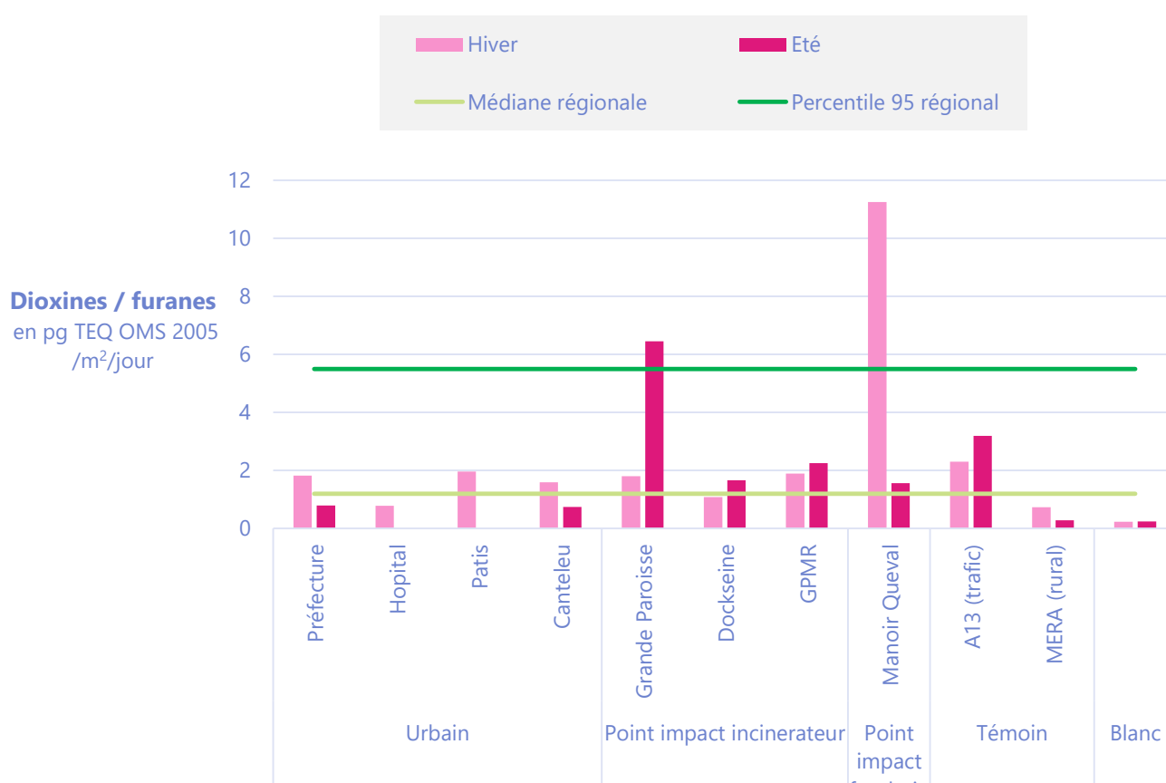
Figure 7 : Résultats des dioxines / furanes dans les jauges comparés aux valeurs repères regionaux
