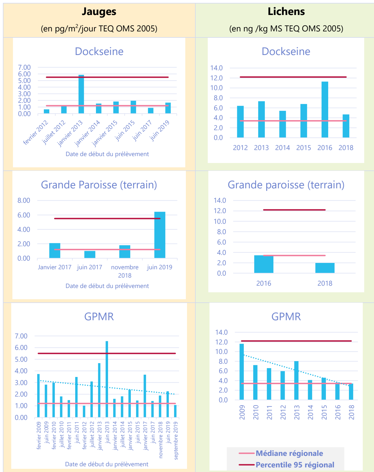
Figure 12 : Evolution des retombées de dioxines / furanes sur 3 sites de mesure sous les vents des incinérateurs
