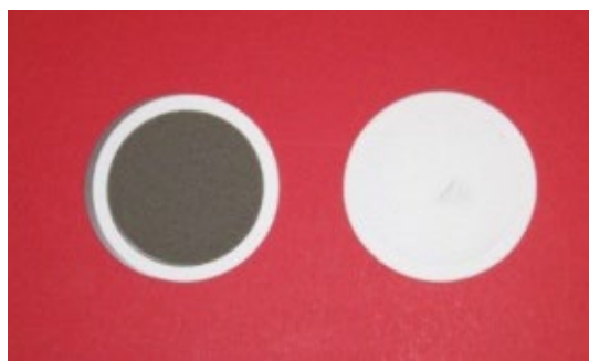
Figure 3 : Exemple de photos de filtres (à gauche un filtre après prélèvement des poussières PM 10 , à droite un filtre vierge)
