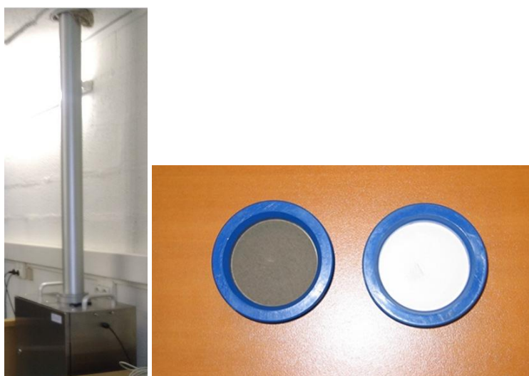
Figure 4 : Photographie de l'appareil de prélèvement et de filtres insérés dans un support de prélèvement.
