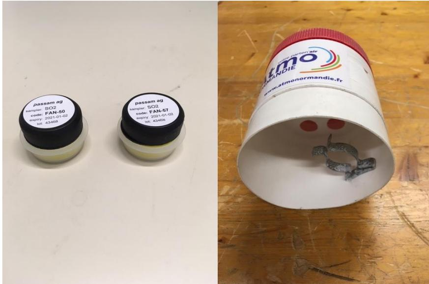
Figure 6 : Photographies des échantillonneurs passifs SO<sub>2</sub> et du boîtier d'installation des tubes, Atmo Normandie, 2020.
