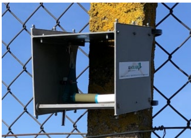
Figure 6 : Boîte de protection d'un échantillonneur passif
