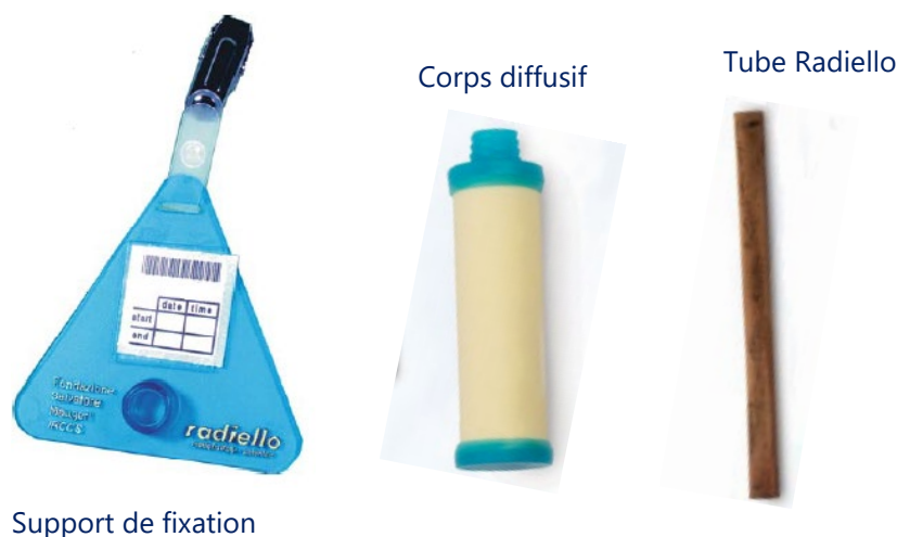
Figure 5 : Éléments constitutifs d'un tube passif Radiello®
