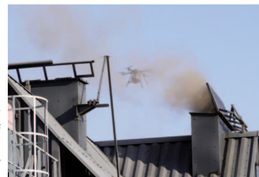
6 novembre 2020, Tourville la Rivière - 1 er test de prélèvement avec un drone en vol équipé d'un canister, sur le centre de formation du SDIS76 1 en partenariat avec Normandie AeroEspace, l'INERIS 2 et la société ABOT.
